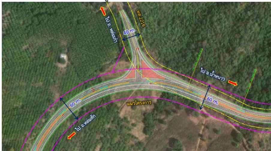
รูปที่ 6.4-11 รูปแบบทางแยกตัดกับ ทล.2216 (ทล.2216 กม.65+320)
