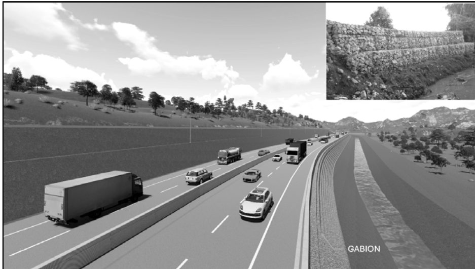
รูปที่ 6.3-4 รูปแบบก่อสร้างกล่องลวดตาข่าย
