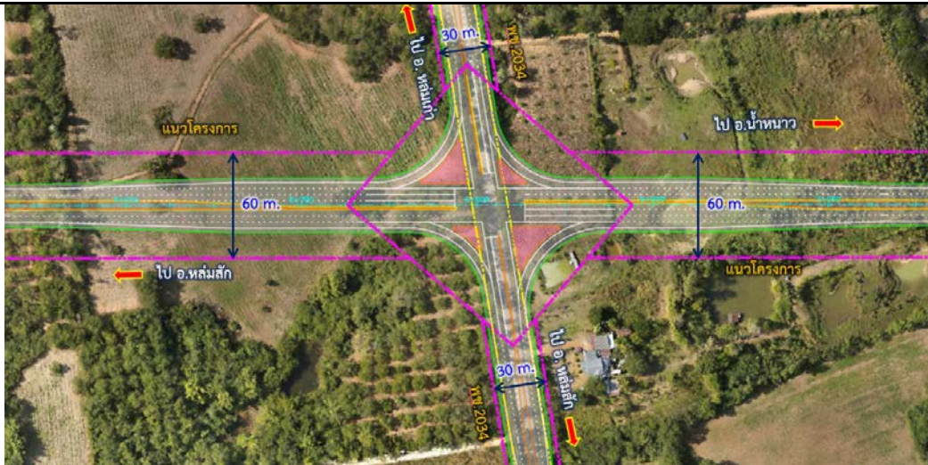
รูปที่ 6.4-6 รูปแบบทางแยก พช.2034 ออกแบบเป็นสี่แยกสัญญาณไฟจราจร
