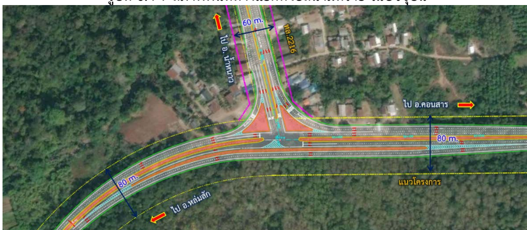
รูปที่ 6.4-8 การออกแบบทางแยก ทล.2216 ตัดกับ ทล.12 (แยกห้วยสนามทราย)
